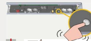
Pulse brevemente el botón de arranque del **MASTER** para lanzar una calibración de todos los módulos.
