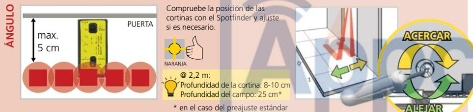
Compruebe la posición de las cortinas con el Spotfinder y ajuste si es necesario.
